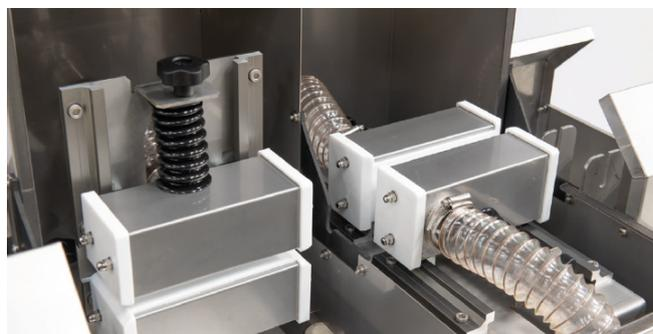
Die Einheit ist vollständig eingehaust, höhenverstellbar und mit einer Grundfläche von 950mm Länge problemlos in fast jede Produktionslinie zu integrieren.
